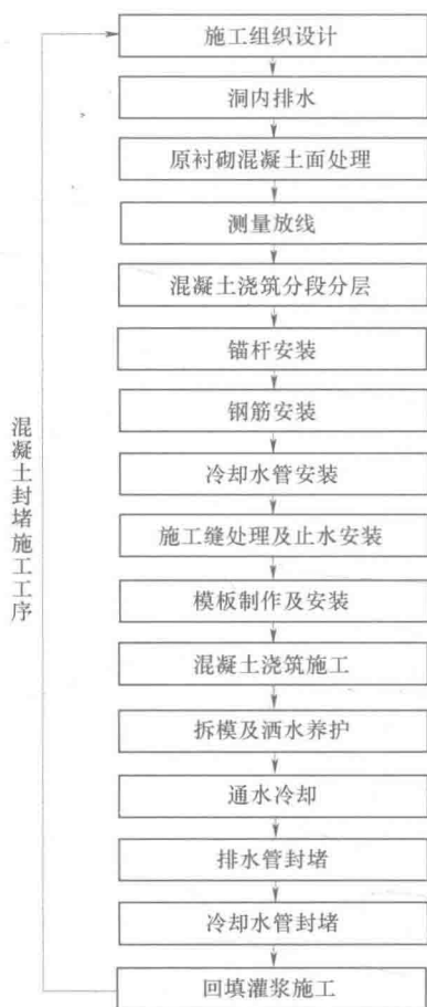
图1 导流洞封堵混凝土施工工艺流程图
