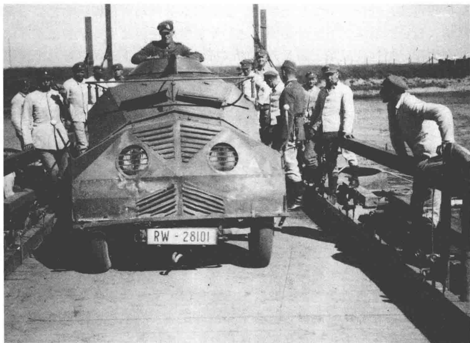
这辆上部安装了金属板的装甲车是从民用版的金鹰标准6型汽车（Adler Standard 6）改装而来的，属于德军早期对装甲车的尝试。该车上部有一圈天线，正通过一座工兵浮桥渡河。
