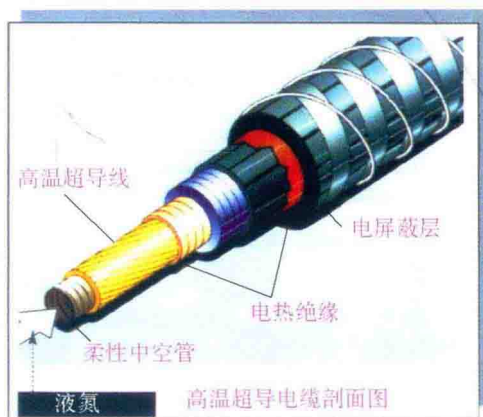
超导电缆结构示意图
