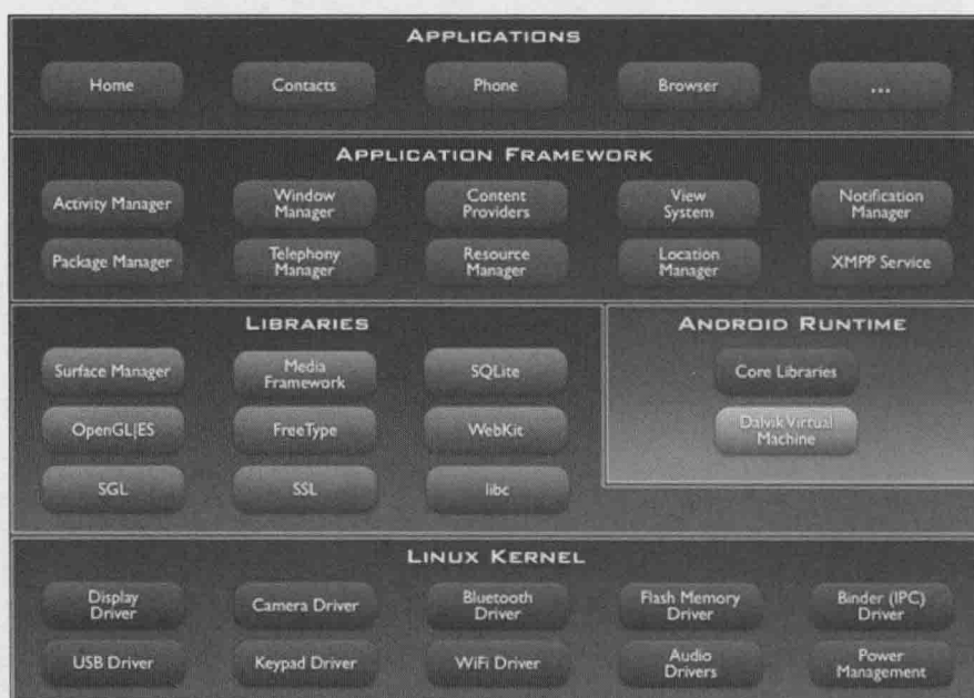
图 1-1 Android 系统架构图
