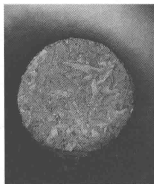
图 1-5 高温过热器弯头氧化皮堆积
