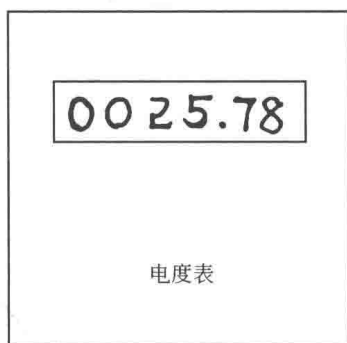
图 1-9 电度表的指示反映出电流做功的多少
