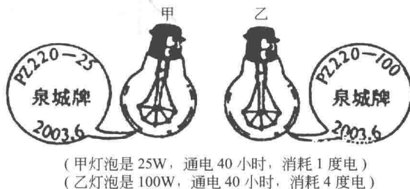
图 1-10 两个不同功率的灯泡在相同时间里消耗的电能不同
