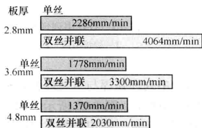
图 1-13 搭接接头焊接速度对比
