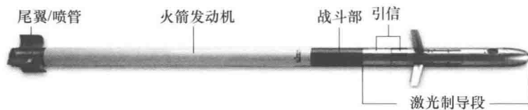
图 1-1 激光制导火箭弹典型结构
