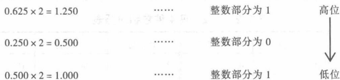
图 1-3 十进制数转换为二进制数的小数部分转换过程
