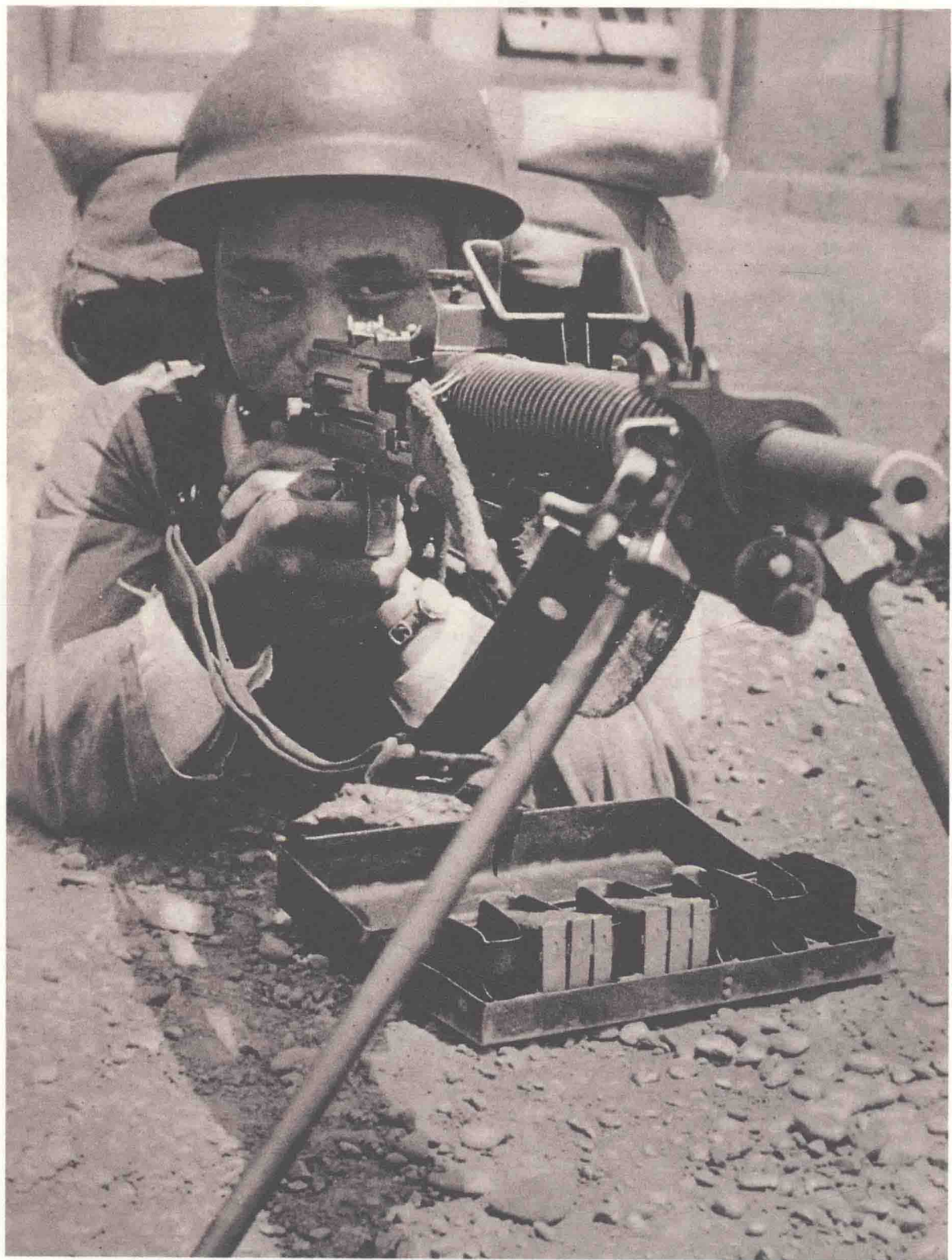
日本轻机枪的射击练习：穿着野战服的一名步兵正在练习轻机枪射击，那挺机枪有两脚架的支撑。它的连发装置是由子弹爆炸时放出的气体来驱动的，并且采用一个可容纳六个弹夹的自动跳弹装置，每个弹夹里有五颗子弹。在机枪下面的盒子里我们还可以看到一些弹夹
