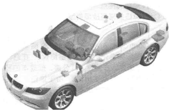
图 1-1 车身上各种控制单元的分布图
