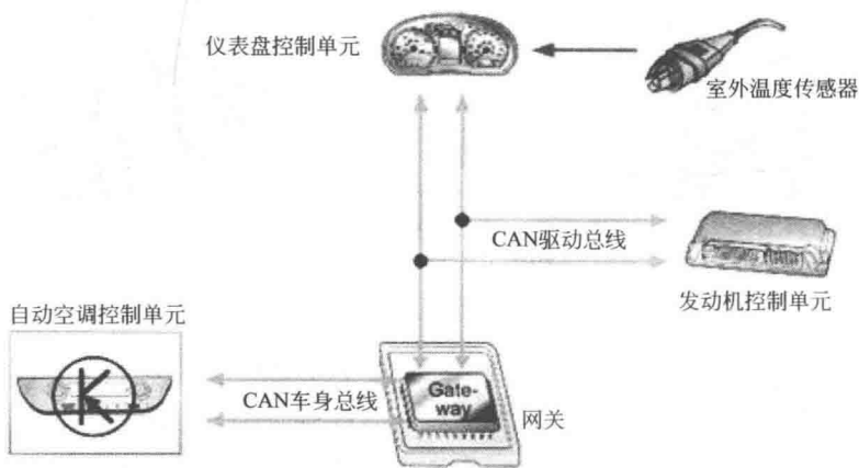
图 1-10 网关在车载网络中起到的“翻译”作用
