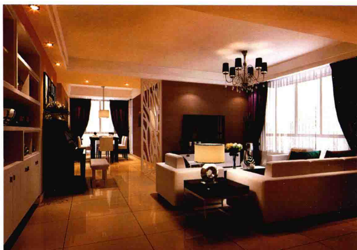
电视墙 [ 墙纸 + 密度板雕花刷白 ]
