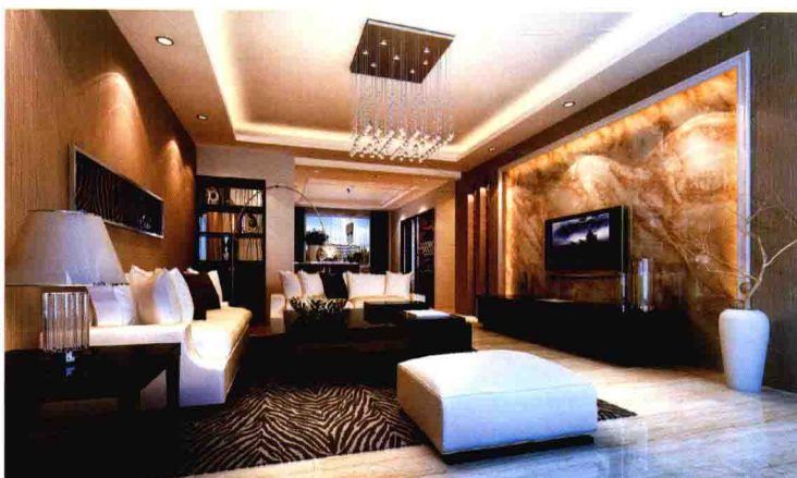
电视墙 [ 微晶石墙砖 + 墙纸 + 木线条刷白收口 ]
