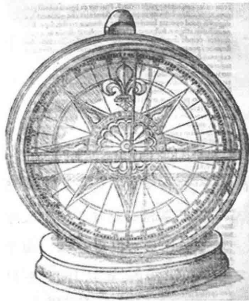
吉尔伯特发明的验证磁场方向的仪器
