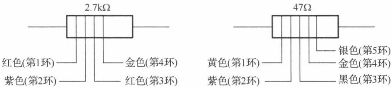
图 2-6 电阻的色环标注法
