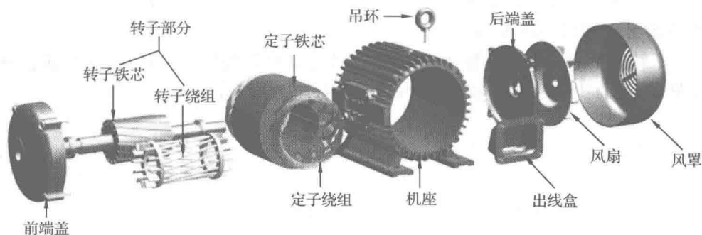
图 1-13 三相异步电动机拆卸示意图
