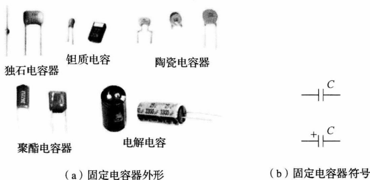
图1-7 固定电容器外形及符号
