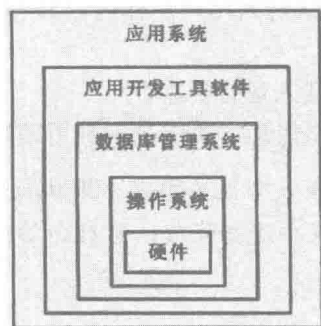
图 1-1 数据库系统的软硬件层次结构
