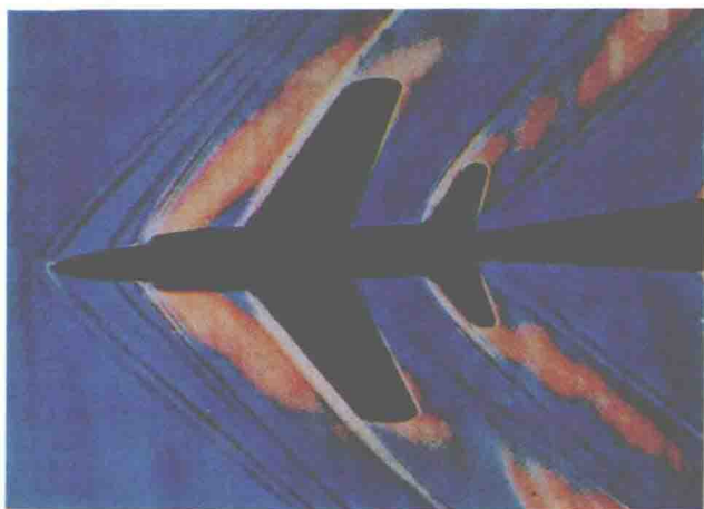
飞机研制的重要试验—— 空气动力试验(图为超音 速风洞测试的纹影照片)。
