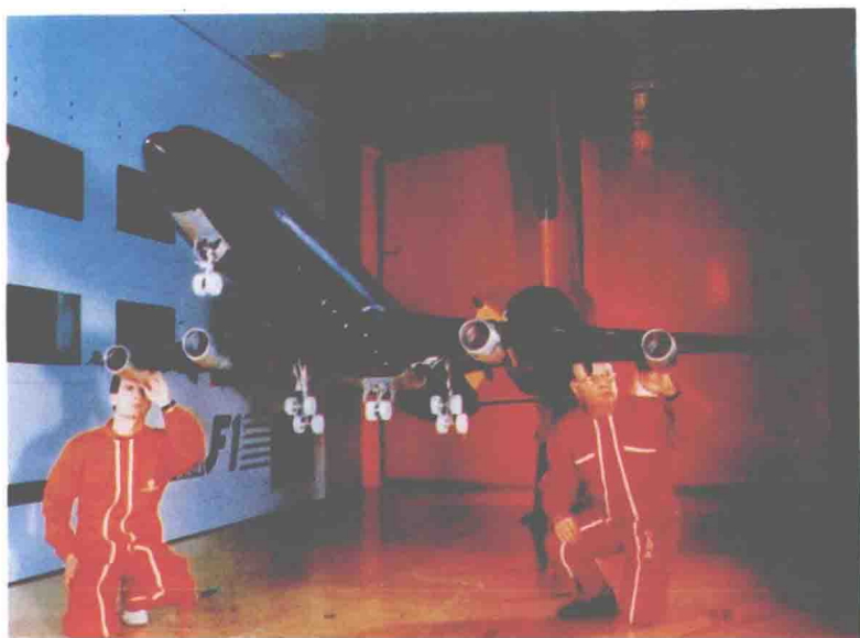
风洞中的运输机模型。
