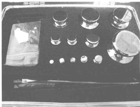
图 2-2 二等（克组、毫克组）砝码标准装置
