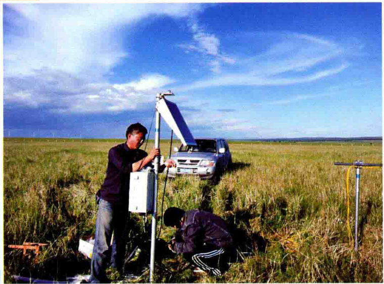
彩图26 “牧区生态高效草原牧养技术模式研究与示范”项目组在内蒙古呼伦贝尔草原安装草地气象环境观测仪器
