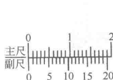
图 2-17 0.05mm 游标卡尺的刻线原理
