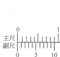
图 2-15 0.1mm 游标卡尺刻度线原理
