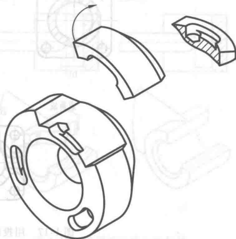
图 1-20 用单一柱面剖切得到的局部剖视图
