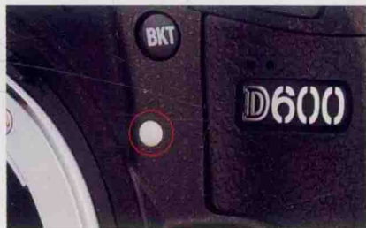
▲安装Nikkor镜头时，先把镜头上的白点对准机身的白点。
