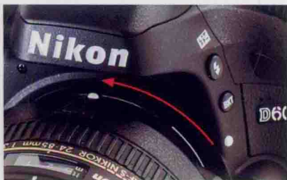
▲然后小心地把镜头插入机身接环内，再逆时针方向旋转镜头并将其锁紧在机身上。
