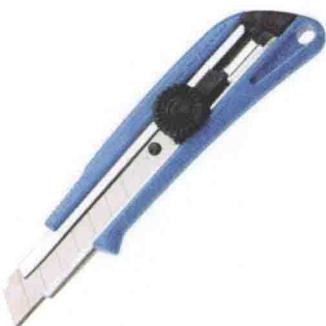
美工刀俗称刻刀或壁纸刀，它是一种美术和做手工艺品用的刀，多由塑刀柄和刀片两部分组成，为抽拉式结构，也有少数是金属刀柄，刀片多为斜口，用钝可顺片身的划线折断，出现新的刀锋，方便使用。
