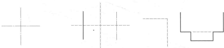
图 10113 图线交接的正确画法
