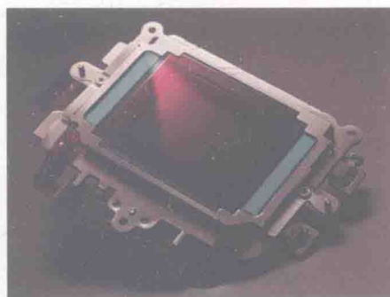
▲ 低通滤镜：这是Canon EOS 1D Mark IV单反相机所用的CMOS影像传感器，正面泛红的就是能过滤红外线的低通滤镜。
