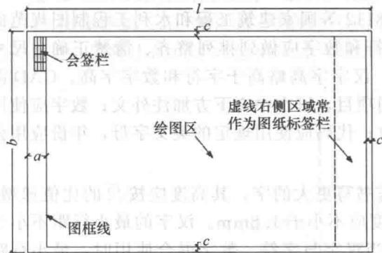
(a) 常用图纸幅面和图框样式
