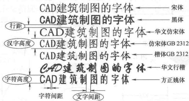
图 1.9 水利工程 CAD 制图字体间距
