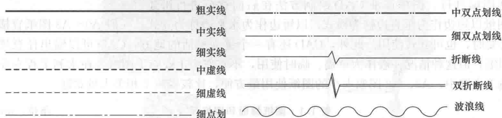
图 1.8 常用水利工程 CAD 制图图线
