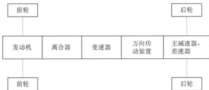
图 1-4 发动机前置后轮驱动传动系统布置示意框图
