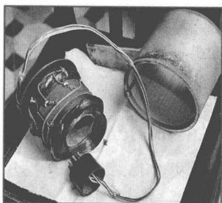
图8 较少枕型失真的偏转线圈
