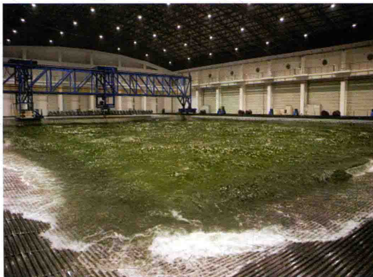
图为设在交大的国家重点实验室的海洋深水试验池，工作井深40米。照片显示正在做风浪流环境下的深海平台试验。
