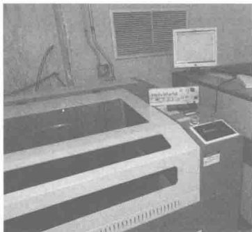
图 1-12 数控激光切割机。
