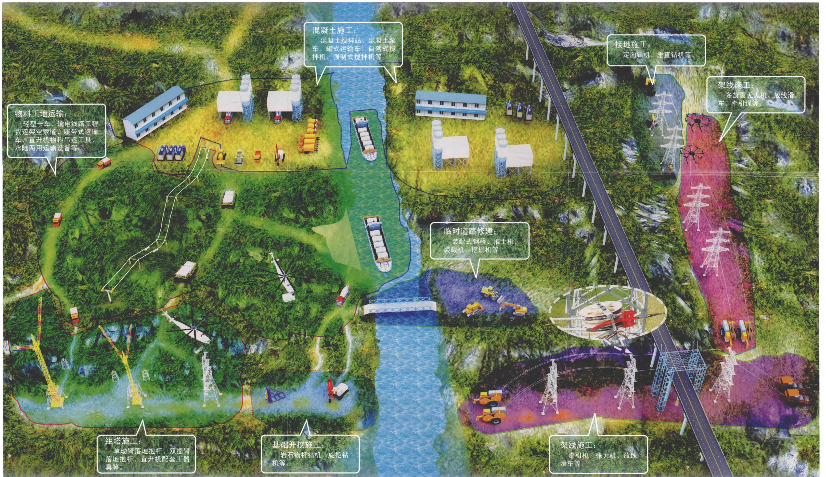
附图 C.1 输电线路全过程机械化施工示意图
