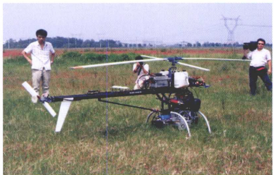
图 1-2 中型无人直升机数据采集系统
