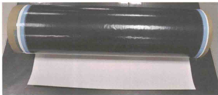
图 1-1 碳纤维平纹织物预浸料
