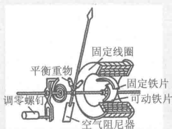
(b) 电磁式仪表测量机构
