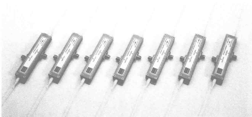
光纤耦合相位和振幅调制器。铌酸锂的普克尔效应被用于调制折射率，从而调节其光信号相位。在振幅调制器中，普克尔效应被应用于调制马克-曾德尔干涉仪两个臂的折射率，继而调节光的输出。( @ JENOPTIK Optical System GmbH )
