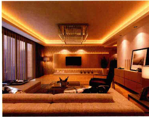
电视墙 [ 墙纸 + 木饰面板 + 灯带 ]
