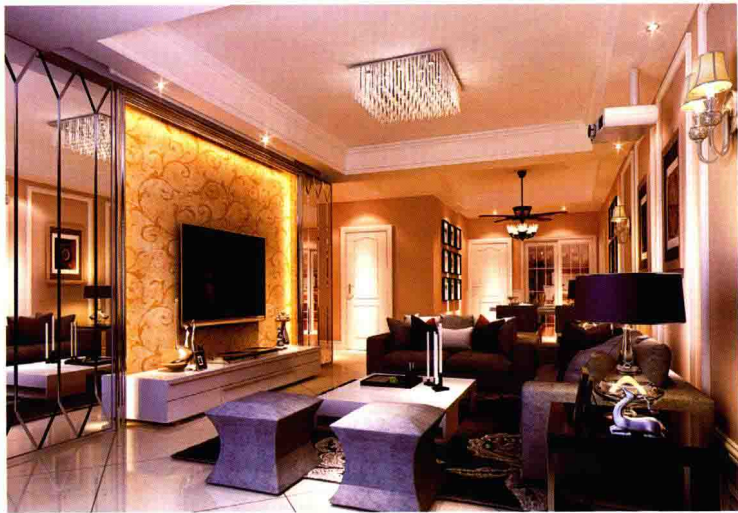
电视墙 [ 墙纸 + 车边银镜倒角 + 木线条装饰框刷银漆 ]
