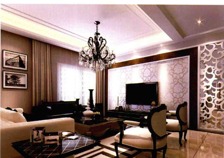
电视墙 [ 墙纸 + 木线条装饰框刷白 + 密度板雕花刷白贴银镜 ]
