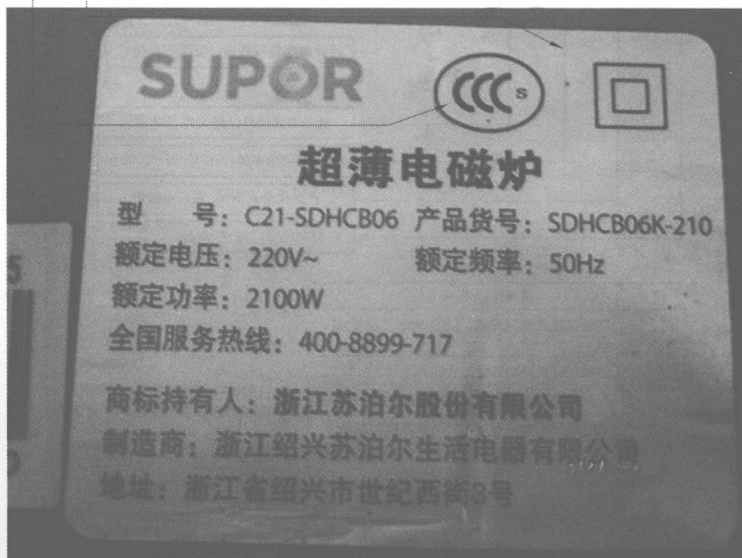
图1-2 苏泊尔电磁炉铭牌
