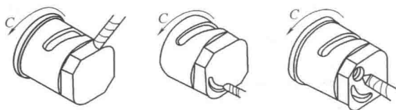
图 1-2 车削中心 C 轴加工能力
