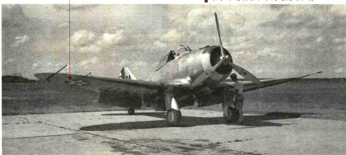
计，发动机的输出功率也相当大。在这些新技术的支持下，P-35战斗机具有飞行速度快、俯冲攻击能力强和航程相当远的特点，且采用合金材料作为蒙皮，增强了机身的抗打击能力。
