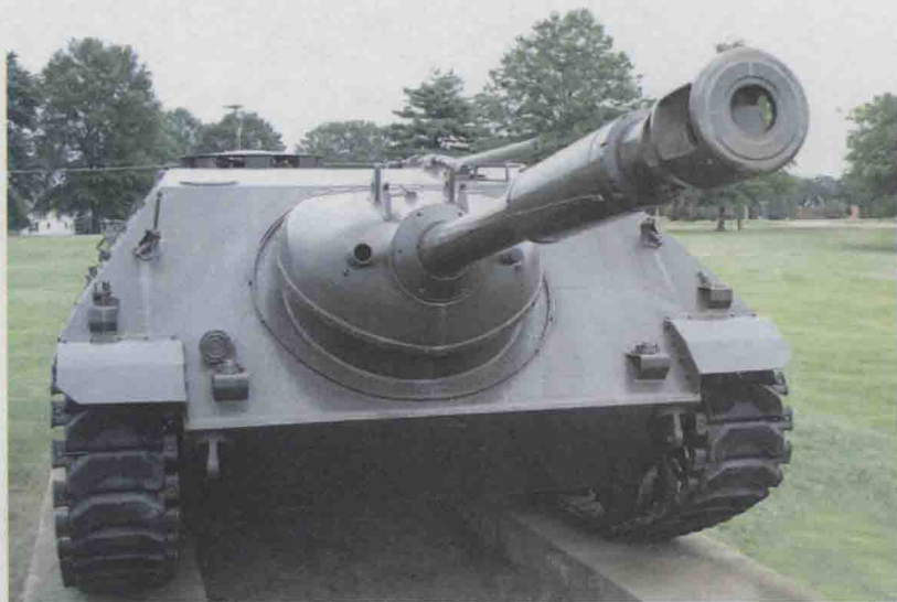
▲ Kanonenjagdpanzer 4-5在设计上重新回归了二战时的无炮塔传统，成为了战后真正意义上的新一代“追猎者”（在设计上颇为“复古”的Kanonenjagdpanzer 4-5当年之所以会出现，至少部分原因是为了弥补Raketenjagdpanzer 2在近距离射击上所存在的缺陷）
