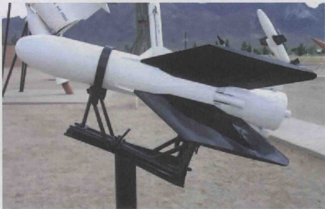
▲ 早期型号的反坦克导弹，大多是采用升降舵和副翼，利用气动力进行控制。这种系统的优点是制造简单、价格便宜。再安上一个陀螺仪，就可以将指令信号传送到相应的控制面上，以完成所要求的机动动作
