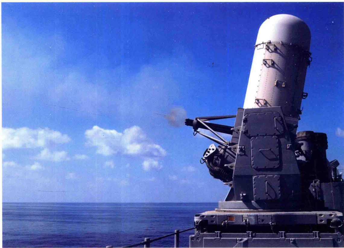
美海军“切斯劳维尔”号巡洋舰上装备的密集阵近防武器系统
