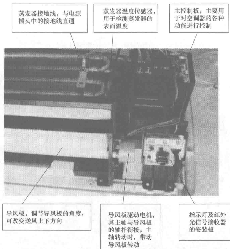
图 1-4 分体挂壁式空调器室内机中主控端基本结构实物图
