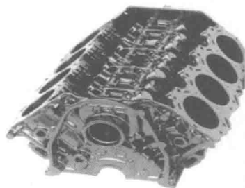
图 1-5 蠕墨铸铁发动机缸体
