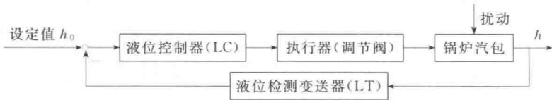
图 1-6 锅炉汽包液位控制系统方框图
