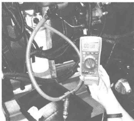
图 1-2 用数字万用表与压力测试模块测量压力
