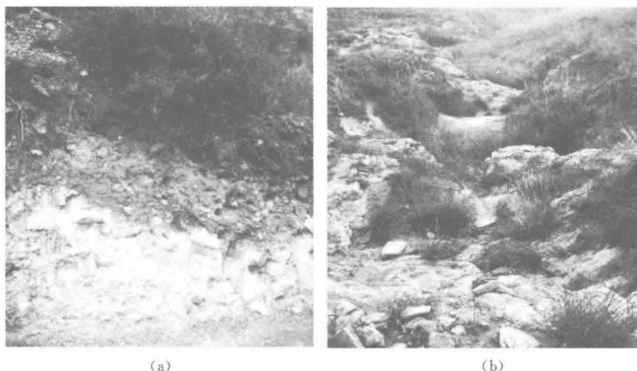
图 1-1 张家口市土壤特征及水蚀现状 (a) 坡脚土壤垂直层理剖面; (b) 坡面水蚀严重程度
