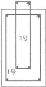
图 2-1 1号、2号箍筋 长度计算示意图
