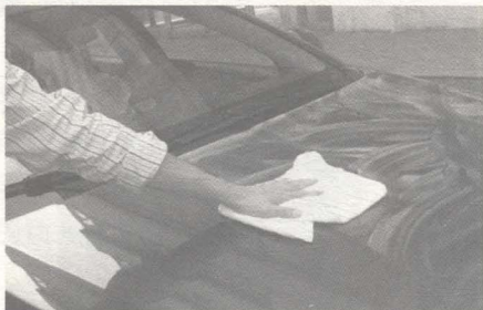
⑤ 涂好车蜡后要略等几分钟，等车蜡变干后，再用软布擦净表面
