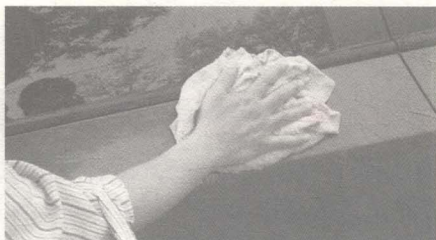
③ 用氧化、微纹去除剂处理风化和氧化的车漆面
