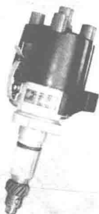
图 1-11 长安微型车 465Q 系列 电喷发动机分电器
